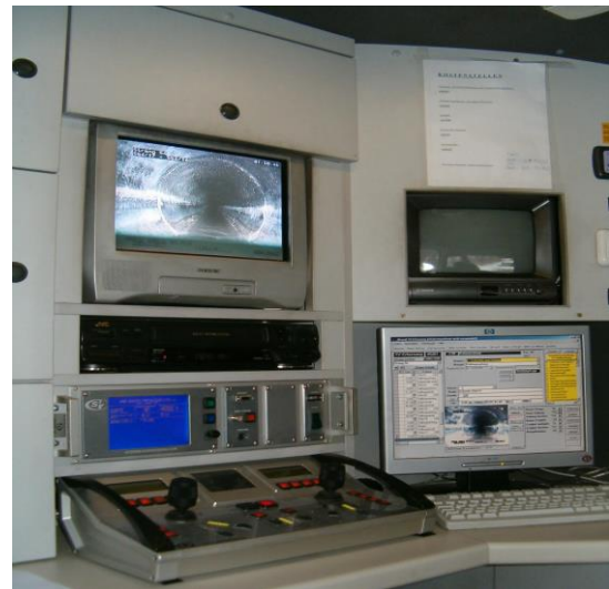
Steuerkonsole im Kanalfernsehwagen
