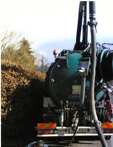
Kanal – Spülfahrzeug mit Hochdruckschlauch
