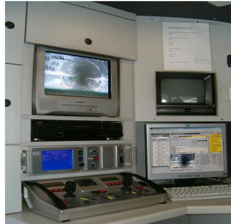
Steuerkonsole im Kanalfernsehwagen
